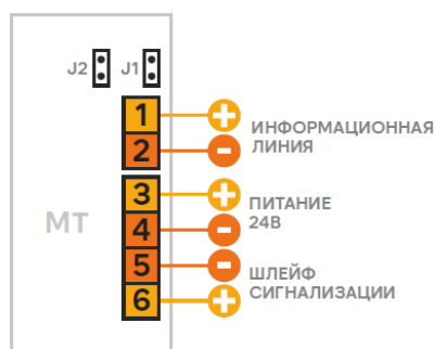
Рис. 2. Назначение клемм адресных меток КУПОЛ-МТ.
